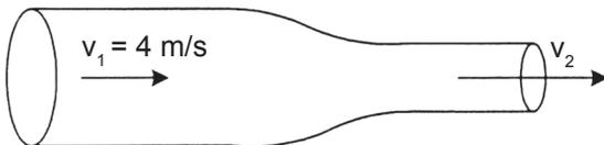
Aliran fluida pada pipa memenuhi kontinuitas.
